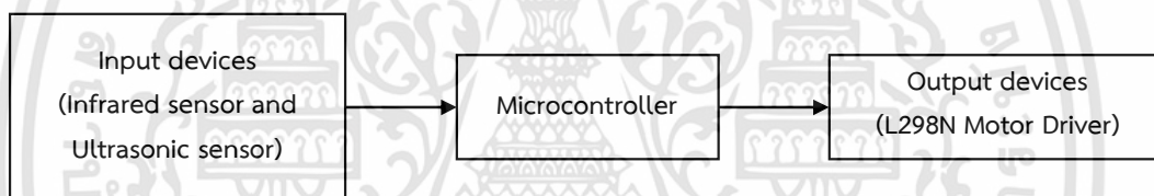
รูปที่ 3.6 บล็อกไดอะแกรมการทำงานของระบบควบคุมการเดินตามเส้น
