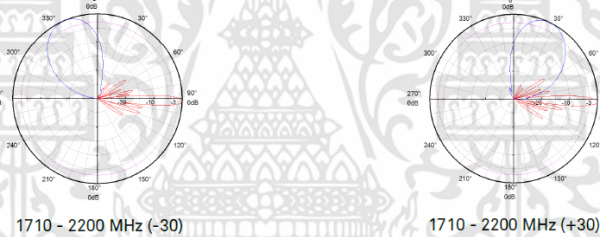
รูปที่ 2.11 ลักษณะการแพร่กระจายคลื่นของแบบจำลอง AMB4520R6V06 [11]
