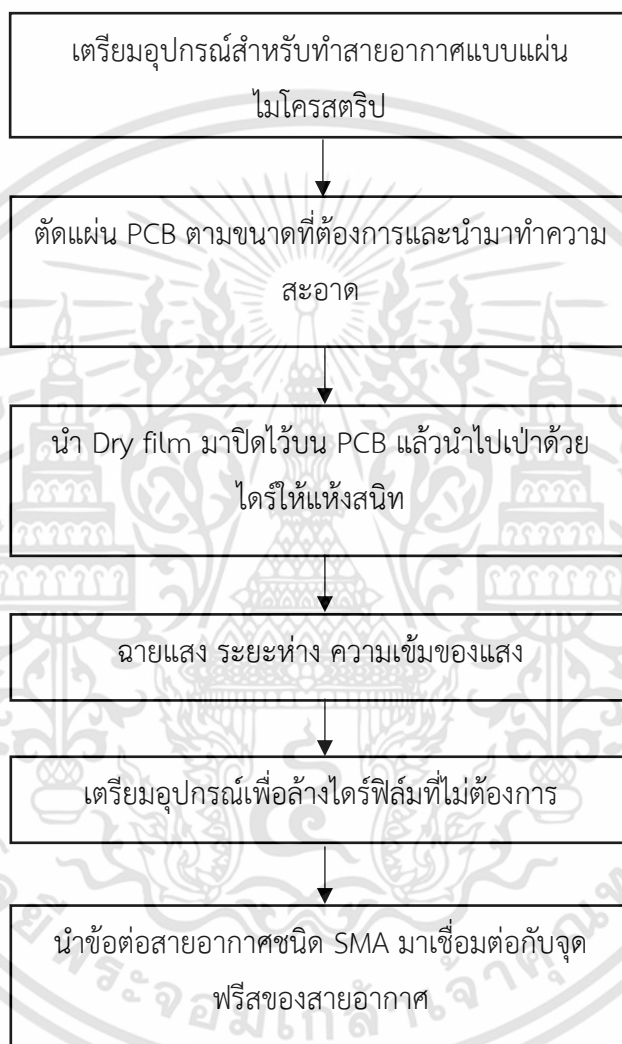
รูปที่ 3.2 บล็อกไดอะแกรมขั้นตอนการสร้างสายอากาศแบบแผ่นไมโครสตริปที่ความถี่ 2.4 กิกะเฮิรตซ์
