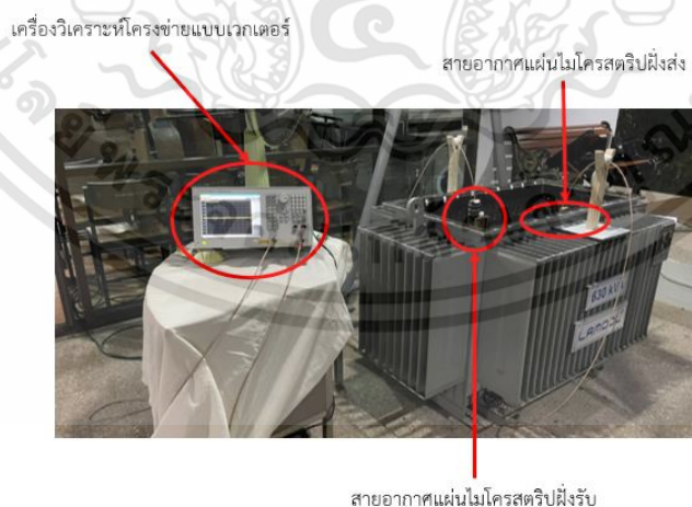
รูปที่ 3.23 การจัดเตรียมอุปกรณ์การทดลองการวัดสัญญาณในหม้อแปลงไฟฟ้าที่ด้านส่งกับด้านรับ 16×16 ตำแหน่ง และ 40×40 ตำแหน่ง กรณีไม่มีสิ่งกีดขวาง
