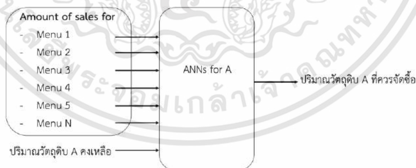
รูปที่ 3.27 แผนภาพการทำงานโดยรวมของระบบทำนายปริมาณวัตถุดิบ
