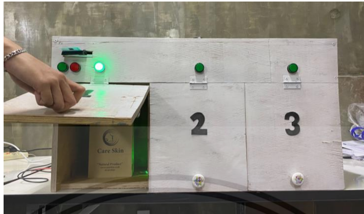
รูปที่ 4.24 สถานะไฟและสถานะกลอนของช่องจ่ายยาหมายเลข 1 : ไฟประจำช่องติด และกลอนไฟฟ้าปลดล็อก
