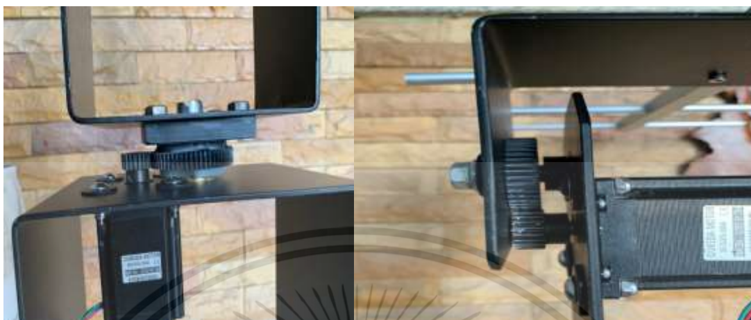
รูปที่ 3.8 และ 3.9 Step motor NEMA 23, ลูกปิ่น ,Pulley gear ในแกนแนวนอน และแนวตั้ง
