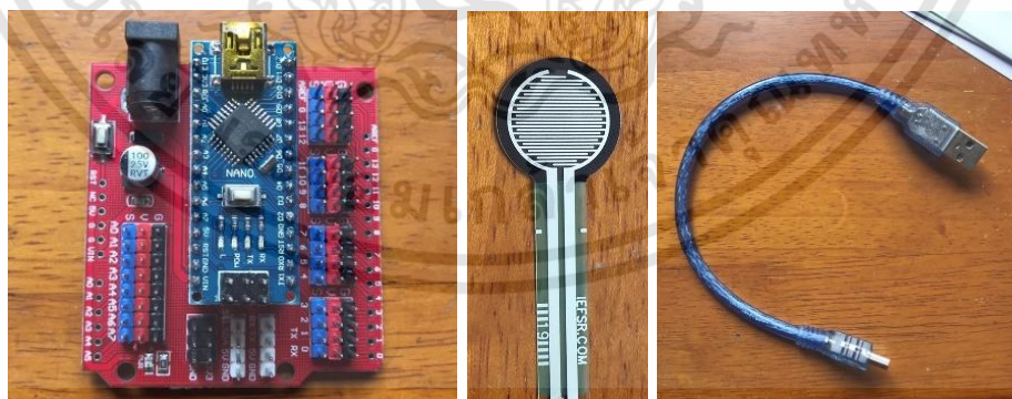
รูปที่ 3.11 อุปกรณ์บอร์ดไมโครคอนโทรลเลอร์ เซนเซอร์วัดแรงกด และสาย Mini USB ตามลำดับ
