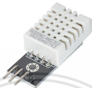
รูปที่ 2.8 โมดูลเซนเซอร์วัดอุณหภูมิและความชื้น DHT22 [9]
