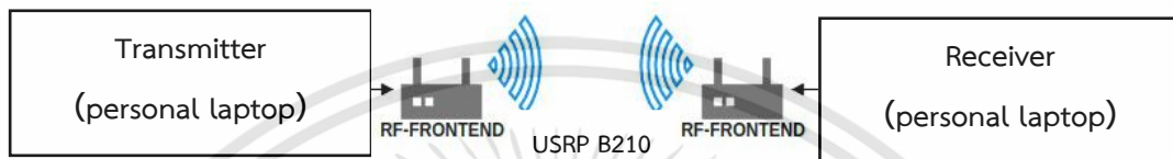
รูปที่ 1.2 แผนภาพการทดสอบด้วย USRP B210
