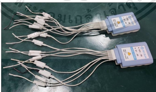
รูปที่ 3.55 Logic probe และสายไฟสำหรับวัดสัญญาณดิจิทัล
