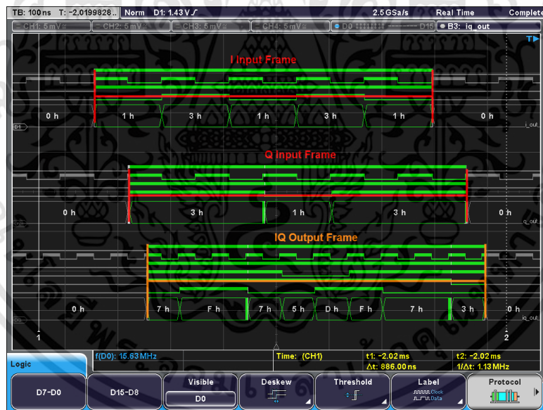
รูปที่ 4.37 ถอดรหัสสัญญาณของวงจร I/Q Pairing บนบอร์ด FPGA ด้วยออสซิลโลสโคป
