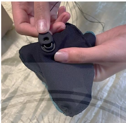
รูปที่ 3.68 การเชื่อมต่อ Electrode กับหมวก
