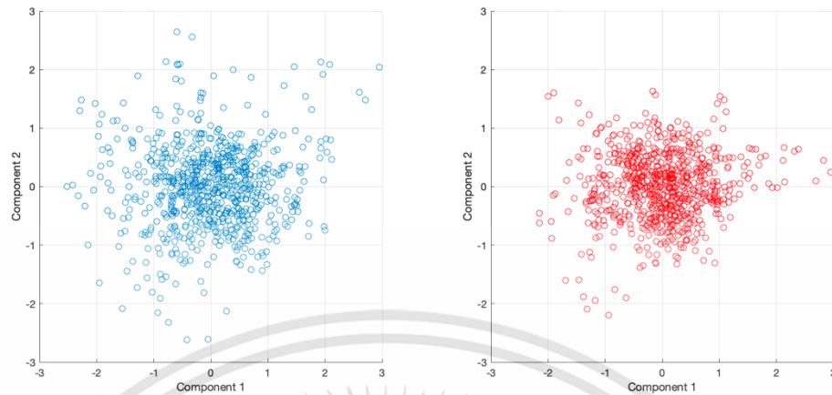
รูปที่ 4.22 ผลลัพธ์ของการกระจายของชุดข้อมูลหลังผ่านอัลกอริธึม CSP โดยใช้ 2 Component แรกของเมทริกซ์ W เมื่ออินพุตของอัลกอริธึม CSP คือชุดข้อมูลเรียนรู้
