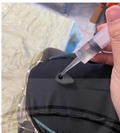
รูปที่ 3.79 การหยอด Unicorn Gel ลงบน Electrode
