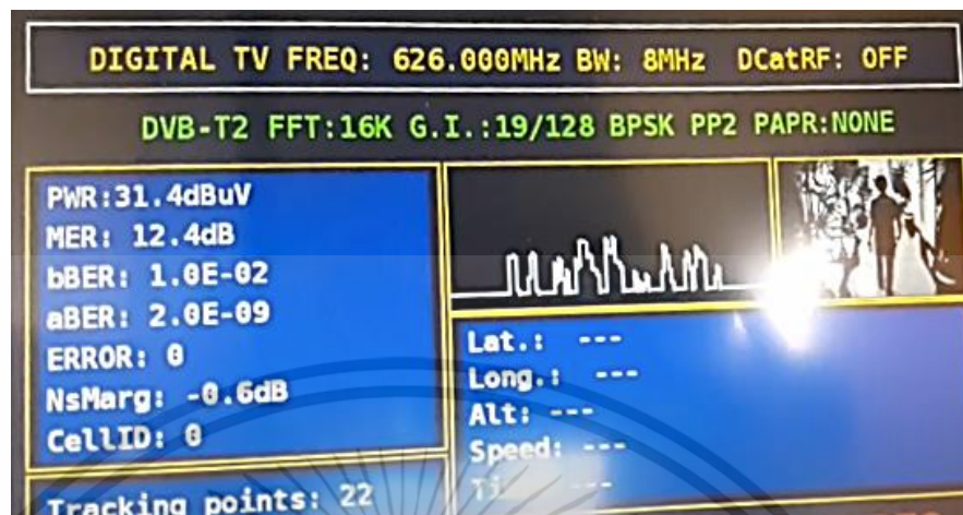
รูปที่ 3.8 การตั้งค่าเครื่องวิเคราะห์แถบความถี่และวัดค่าความแรงของสัญญาณที่ได้รับ
