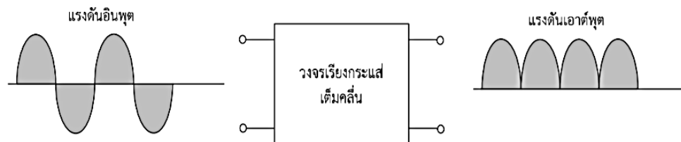
รูปที่ 2.5 แผนภาพของวงจรเรียงกระแสแบบเต็มคลื่น
