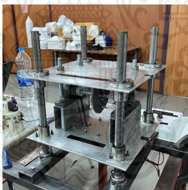
รูปที่ 3.1 โครงสร้างสำหรับการติดตั้งตัวดูดซับการสั่นสะเทือน
