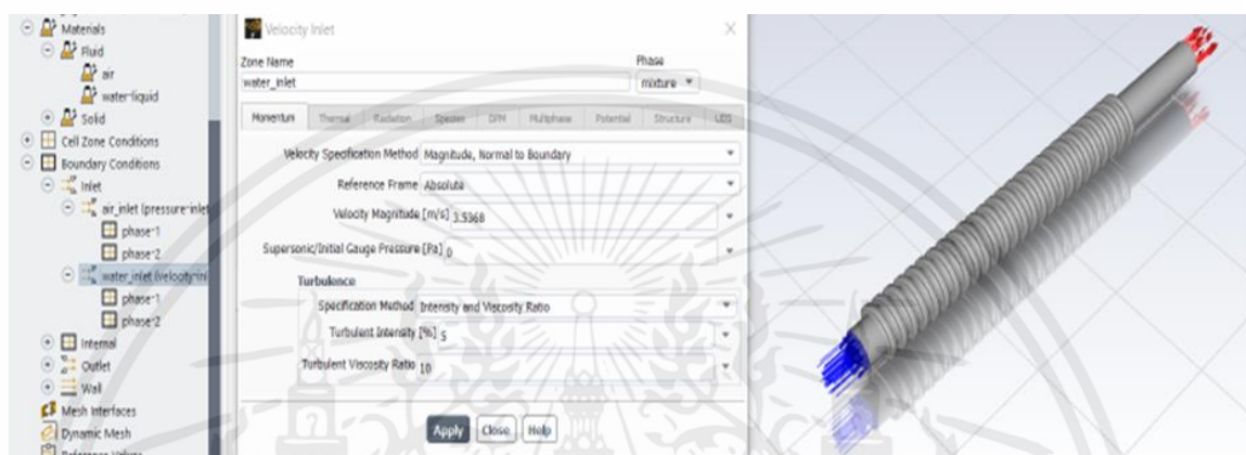
รูปที่ 8 การตั้งค่าเงื่อนไขขอบเขตในโปรแกรม Fluent
