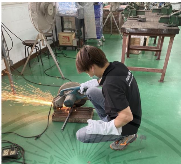
รูปที่ 4.2 ตัดขนาดเหล็กให้ได้ความยาวพอเหมาะสำหรับเชื่อมไฟฟ้า
