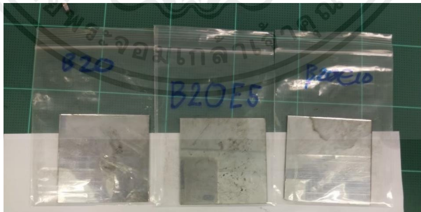
รูปที่ 3.6 เขม่าที่เก็บได้ของแต่ละเชื้อเพลิง
