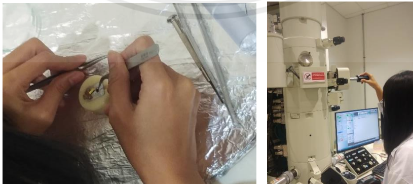
รูปที่ 3.11 เตรียมแผ่นกริดของเขม่าเข้าเครื่อง TEM
