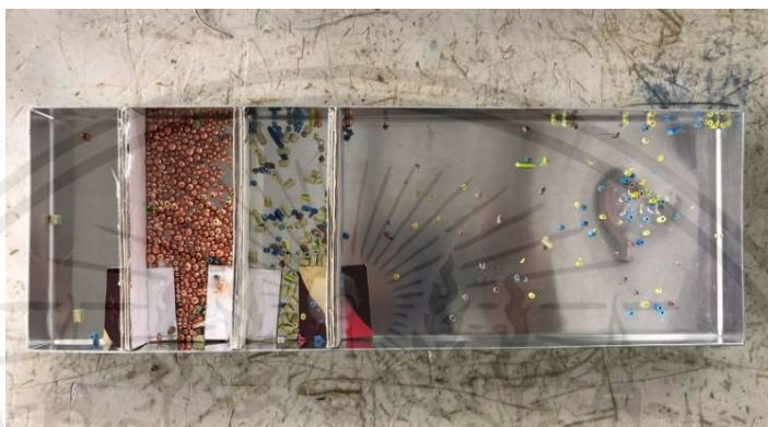
รูปที่ 4.25 แสดงผลการทดลองของวัสดุเนื้อผสมสองชนิดคือ ฉนวนหุ้มสายไฟ 8 กรัม และทองแดง 40 กรัม
