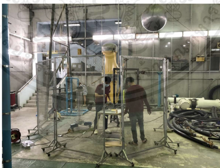
รูปที่ 4.3 แสดงการเตรียมการทดลองและบริเวณรั้วศักย์ไฟฟ้าสูง
