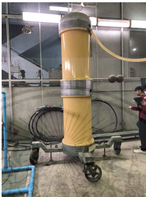
รูปที่ 3.26 หม้อแปลงแรงดันสูงกระแสตรง
