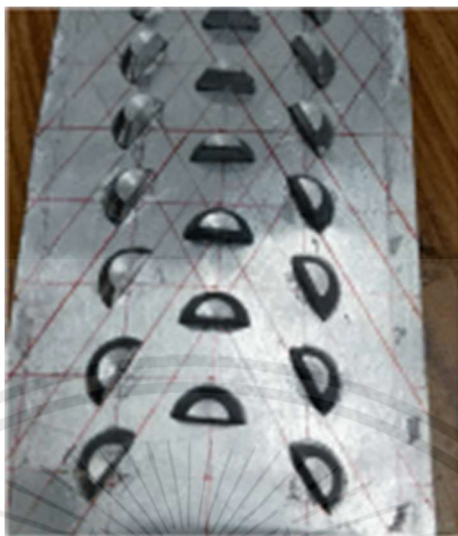
รูปที่ 2.8 อุปกรณ์สร้างกระแสมุนคองตามแนวยาวแบบทรงกรวยและติดแบบเอียง
