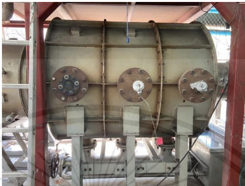
รูปที่ 2.5 ห้องเผาไหม้เชื้อเพลิง (Furnace)
