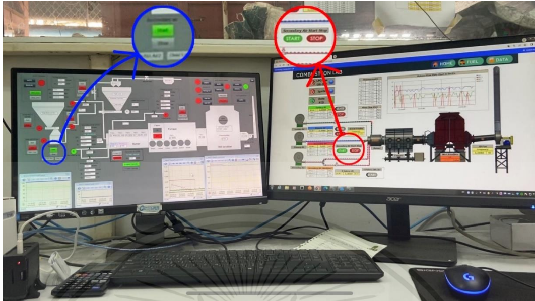
รูปที่ 5.2 แสดงการเปรียบเทียบการทำงานระหว่างหน้าเว็บ Cloud SCADA และหน้าโปรแกรม WinCC เมื่อสั่งเปิดอากาศส่วนที่สอง
