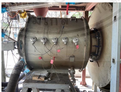
รูปที่ 2.4 หัวเผาเชื้อเพลิงชีวมวลชนิดห้องเผาไหม้ช่วย (Pre-chamber)
