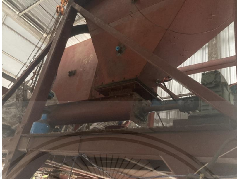
รูปที่ 4.9 แสดงชุดสกรูลำเลียงเชื้อเพลิง
