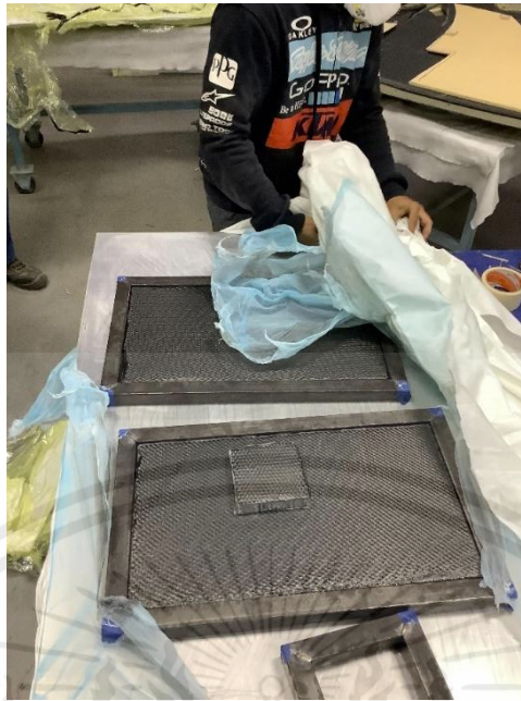
ภาพที่ 4.10 แสดงการแกะชิ้นงานทดสอบออกจากแม่พิมพ์
