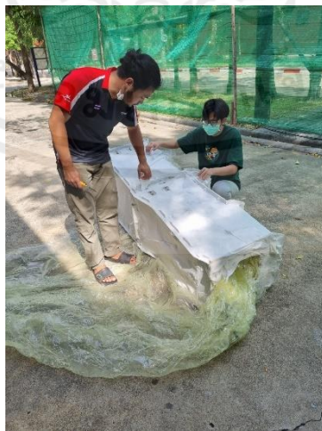
ภาพที่ 6.15 แสดงการนำชิ้นงานออกจาก Vacuum Bag
