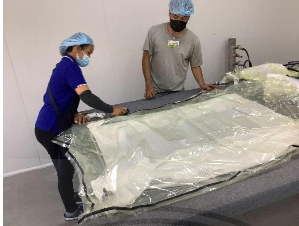
ภาพที่ 4.8 แสดงการนำชิ้นงานเข้าไปใน Bagging Film
