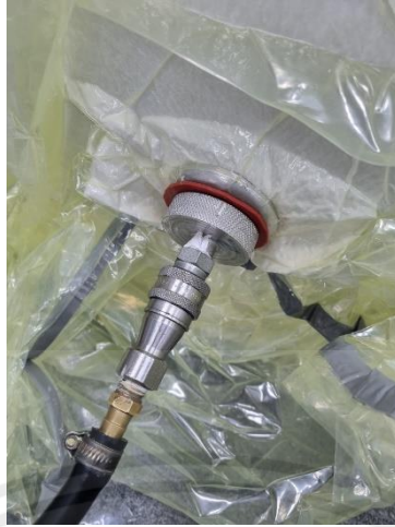
ภาพที่ 6.13 แสดงการดูดอากาศออกจาก Vacuum Bag
