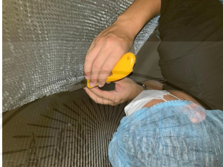
ภาพที่ 6.8 แสดงการ Aluminum Honeycomb ลงบนชิ้นงาน
