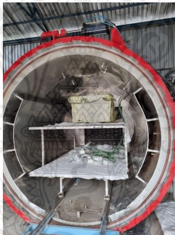
ภาพที่ 6.7 แสดงการนำชิ้นงานเข้าอบใน Autoclave
