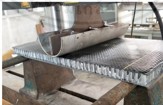
ภาพที่ 4.11 แสดงการทดสอบ 3-Point Bending
