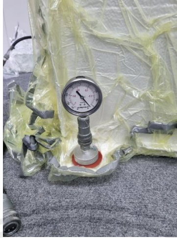
ภาพที่ 6.6 แสดงวิธีการใช้ครีว Vacuum Bag
