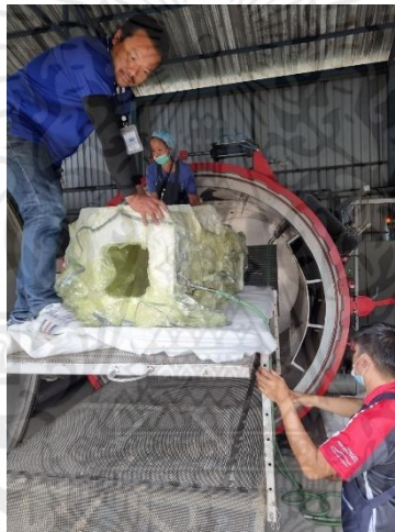
ภาพที่ 6.14 แสดงการนำชิ้นงานเข้าอบใน Autoclave
