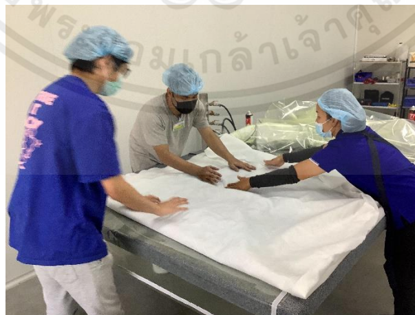
ภาพที่ 4.7 แสดงการห่อชิ้นงานด้วย Bleeder Fabric
