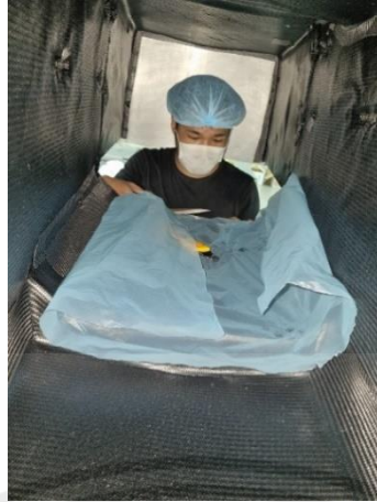
ภาพที่ 6.10 แสดงการวาง Release Film
