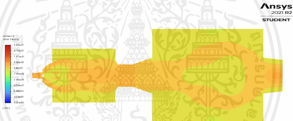
รูปที่ 5.14 แสดงความเร็วการไหลภายในห้องเผาไหม้ที่ติดตั้งหัวเผาขนาด 1 เซนติเมตร
