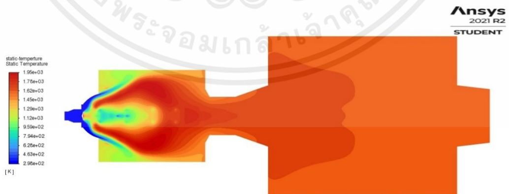
รูปที่ 5.11 แสดงอุณหภูมิภายในห้องเผาไหม้ที่ติดตั้งหัวเผาขนาด 1.25 เท้า
