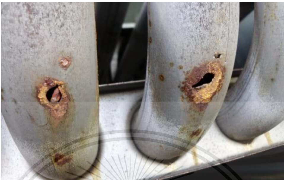
รูปที่ 2.5 การกัดเซาะในท่อรูปตัว U [3]
