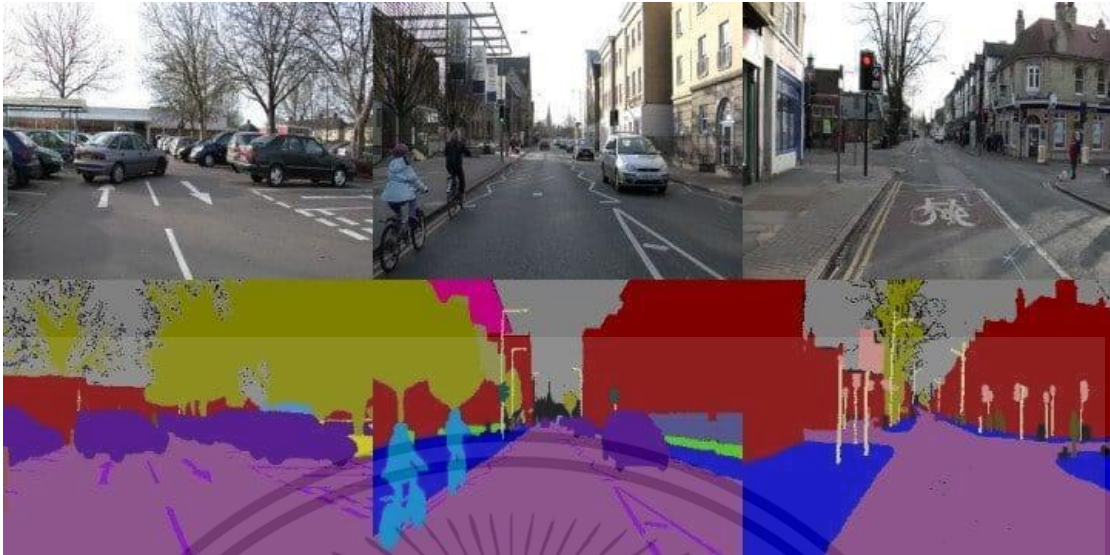
รูปที่ 2.21 การตรวจจ็บบรูปภาพโดยใช้วิธีถมสีให้ทุก Pixel ของวัตถุนั้น [9]
