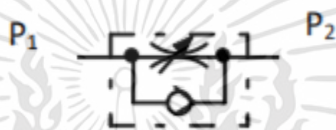
รูปที่ 2.21 สัญลักษณ์ของวาล์วควบคุมอัตราการไหลทางเดียว (One way flow control valve) [7]
