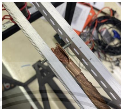
รูปที่ 3.19 แสดงการประกอบทางปลาเพื่อปรับระดับความตึงเชือกของสายส่ง
