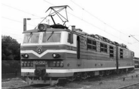
รูปที่ 2.3 หัวรถจักรไฟฟ้ารุ่น 8G ใช้แพนโทกราฟแขนคู่สองคานรูปทรงเพชร (Four-cantilever diamond double-arm frames) [4]
