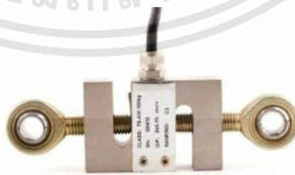
รูปที่ 2.33 รูปแสดงโหลดเซลล์แบบเอสบีเอ็ม (S-Beam load cell) [9]
