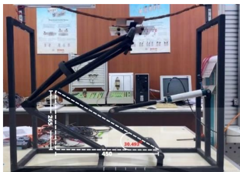
รูปที่ 3.58 แสดงการหามุมของชิ้นส่วนที่ 2 ขณะสัมผัสสายส่งจุดที่ 2
