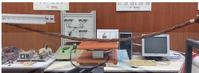
รูปที่ 3.53 แสดงการสัมผัสของสายส่งและโหลดเซลล์ (Load cell) ที่จุดสัมผัสที่ 2
