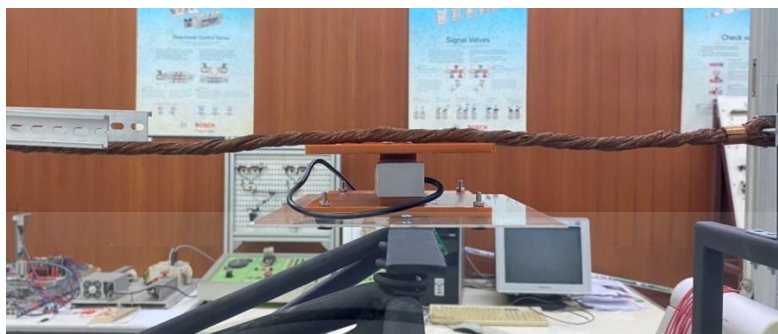
รูปที่ 3.67 แสดงสถานะสมดุลของสายส่งบนโหลดเซลล์ (Load cell)
