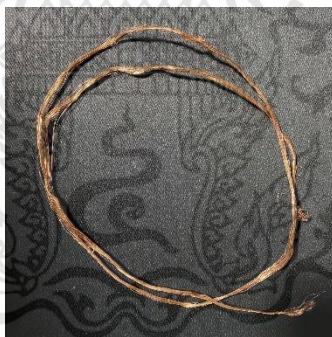
รูปที่ 3.8 สายทองแดงเปลือยภายในสายซิลิโคน
