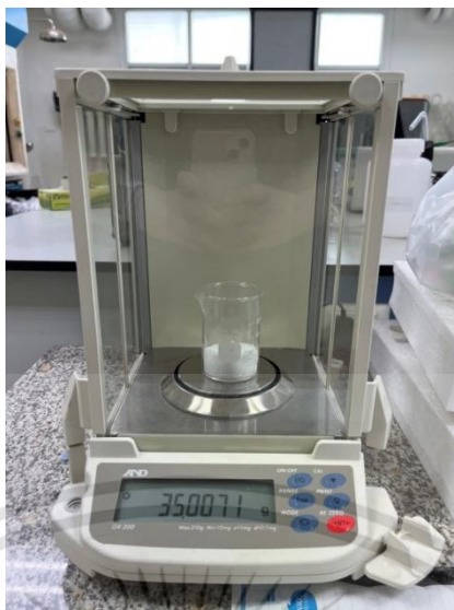
รูปที่ 3.38 การชั่งตวงเกลือเคมี 35 กรัม เพื่อใช้เป็นสารละลายโซเดียมคลอไรด์
