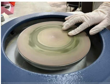
รูปที่ 3.32 ภาพระหว่างการขัด diamond polishing
