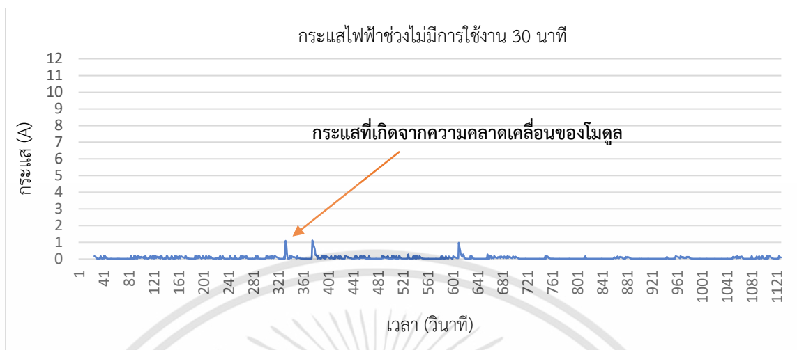
รูปที่ 4.2 สภาวะสถานะปั้มน้ำไม่มีการทำงาน
