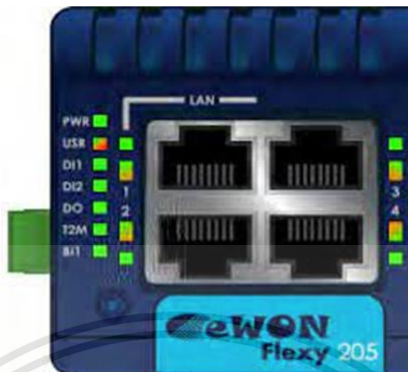
รูปที่ 3.22 Port การเชื่อมต่อสายอีเทอร์เน็ตของอุปกรณ์ Flexy205
