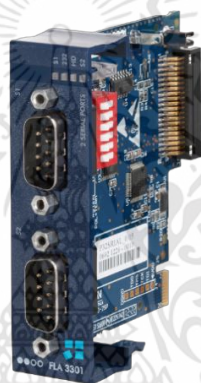
รูปที่ 3.4 ตัวแปลงสัญญาณจาก RS485 เป็น RS232
