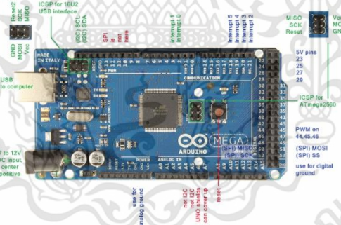
รูปที่ 2.11 แสดงรายละเอียดแต่ละ Pin ของ Arduino Mega 2560
