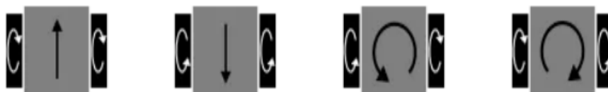
รูปที่ 2.2 รูปแบบการเลี้ยว ของรถยนต์ Differential Drive
