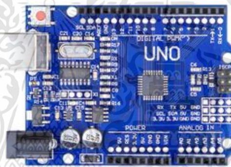
รูปที่ 2.7 บอร์ดไมโครคอนโทรลเลอร์ Arduino Uno R3
