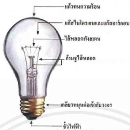
รูปที่ 2.2 โครงสร้างหลอดไส้
