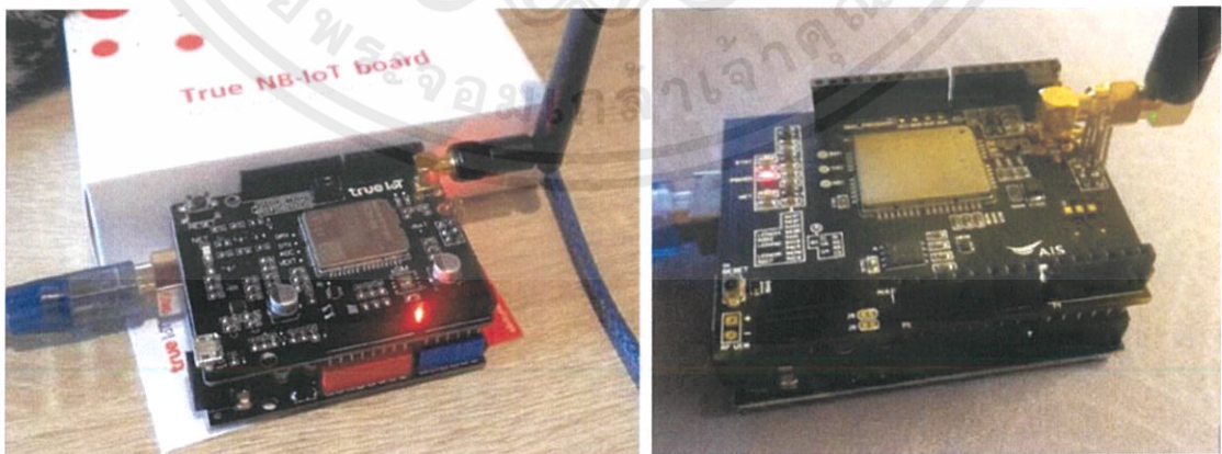
รูปที่ 2.26 NB-IoT Shield สำหรับ Arduino TRUE (ซ้าย) AIS (ขวา)
