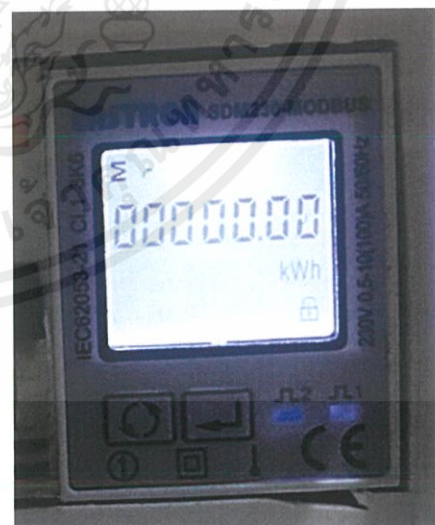
รูปที่ 3.38 ค่า kWh ของ Easton SDM230 เมื่อเริ่มทำการทดสอบ
