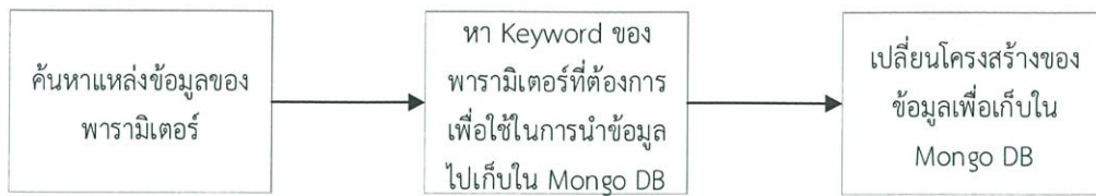
รูปที่ 3.14 บล็อกไดอะแกรมการนำข้อมูลไปเก็บใน Mongo DB
