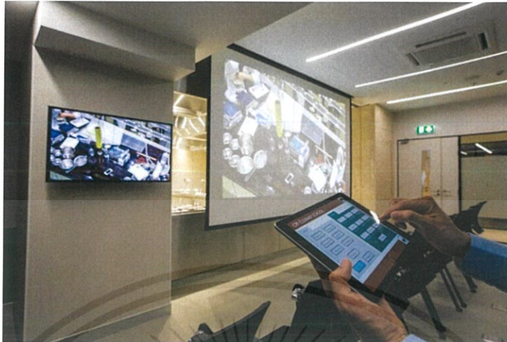
รูปที่ ข.8 โครงการ : CULINEUR, School of Culinary Arts and Entrepreneurship การใช้งาน GUI จริงในการควบคุมอุปกรณ์ภายในห้องเรียน
