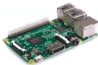
รูปที่ 2.11 บอร์ดราสเบอร์รี่พาย 3 (Raspberry pi 3)
