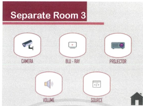
รูปที่ ข.10 หน้าจอ GUI ที่ออกแบบให้กับศาลาว่าการกรุงเทพ โดยใช้ควบคุมห้องจัดเลี้ยงของทางสำนักงาน
