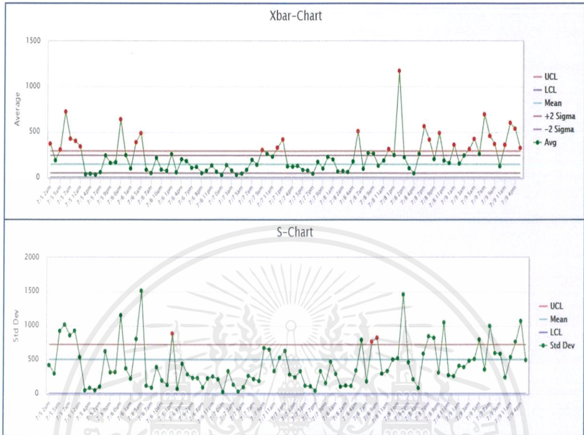
รูปที่ 1.4 ตัวอย่างกราฟ SPC ที่ทีมวิศวกรแผนก Drive Process Engineering ใช้สำหรับควบคุมข้อมูล ที่สนใจในการผลิตฮาร์ดดิสก์
