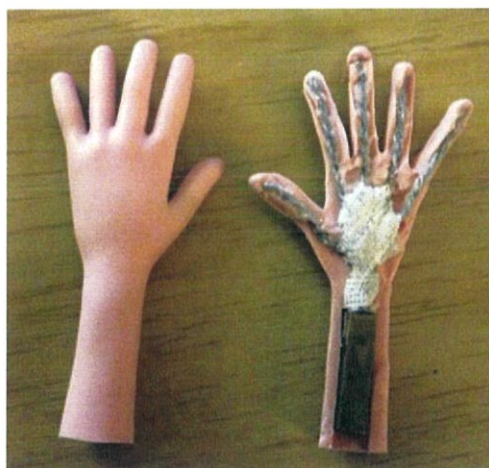
ภาพที่ 2.10 ภาพใช้ซิลิโคนหล่อทับโครงสร้าง
