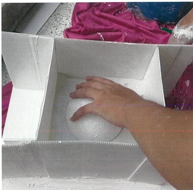
ภาพที่ 4.20 ขั้นตอนการทำพิมพ์โลกและดวงจันทร์
