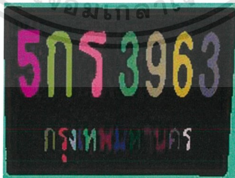
รูปที่ 4.9 ภาพเมื่อผ่าน Connected Component Labeling
