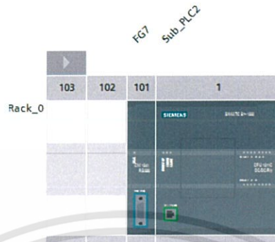
รูปที่ 3.11 การกำหนดอุปกรณ์ Sub PLC2 ในซอฟต์แวร์ TIA Portal
