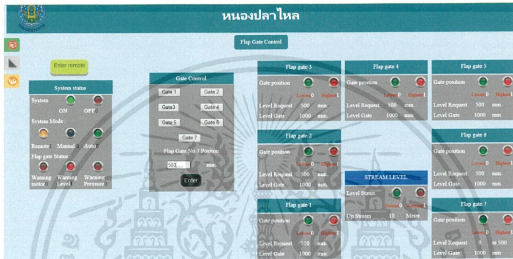
รูปที่ 4.12 ทดสอบการลดระดับฝายพับที่ 7 ส่วนที่ 2
