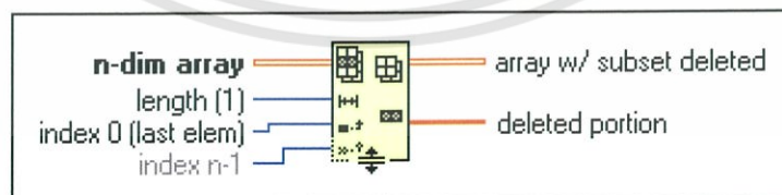
รูปที่3.26 ตัวอย่างการใช้งาน Delete From Array Function
