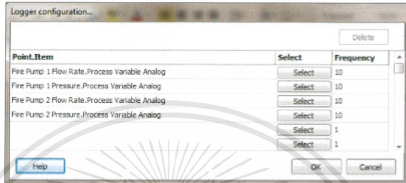
ภาพที่ 3.13 ตัวอย่างการเลือก Tags ในฟังก์ชัน Data logger
