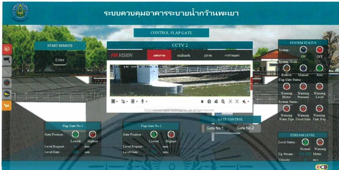
ภาพที่ 3.52 Flap gates control page in web application
