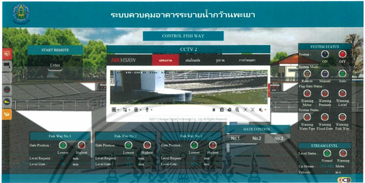
ภาพที่ 3.54 Fish way control page in web application
