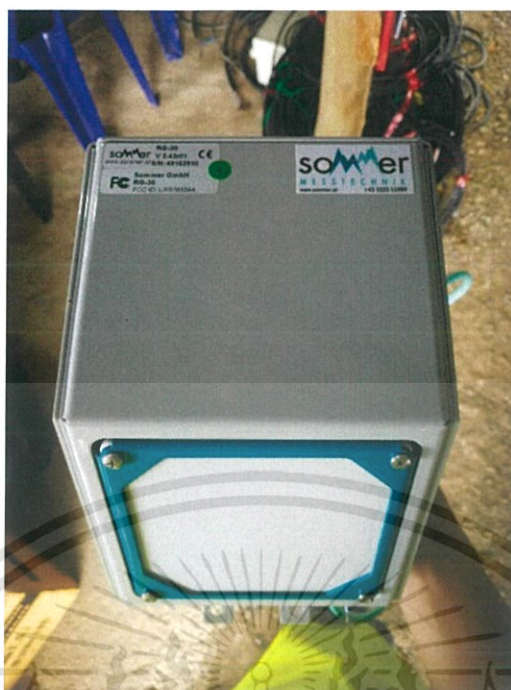
ภาพที่ 2.21 เซนเซอร์วัดความเร็วกระแสน้ำด้วยเรดาร์
