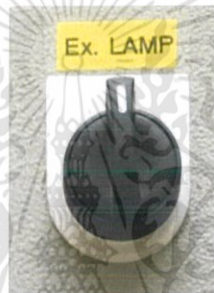
รูปที่ 3.45 ซีเล็คเตอร์สวิตช์สองตำแหน่งสำหรับเปิด-ปิด หลอด LED
