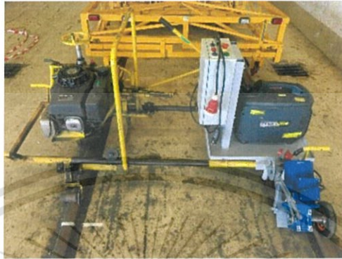
รูปที่ 3.37 เครื่องเจียรรางรูน MV-03 พร้อมติดตั้งระบบขับเคลื่อน
