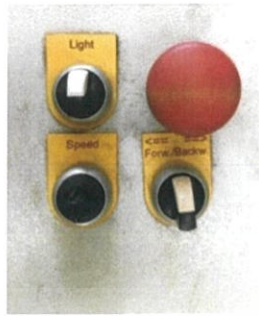
รูปที่ 3.5 ด้านบนของตัวควบคุมมอเตอร์ของเครื่องเจียรรางรุ่น RG-1
