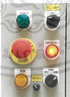
รูปที่ 3.49 ไฟลอตแลมป์แสดงสถานะการหยุดฉุกเฉิน
