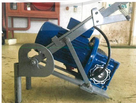
รูปที่ 3.36 ชุดมอเตอร์สำหรับเครื่องเจียรรางรุ่น MV-03
