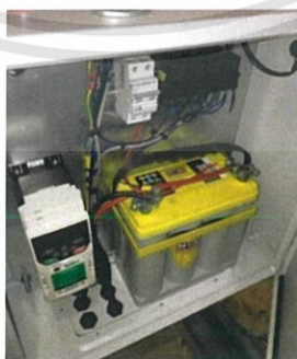
รูปที่ 3.6 ส่วนประกอบภายในตัวควบคุมมอเตอร์ของเครื่องเจียรรางรุ่น RG-1
