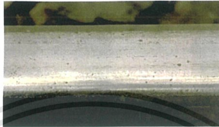
รูปที่ 2.3 ความบกพร่องแบบ Head Check ระดับที่ 5
