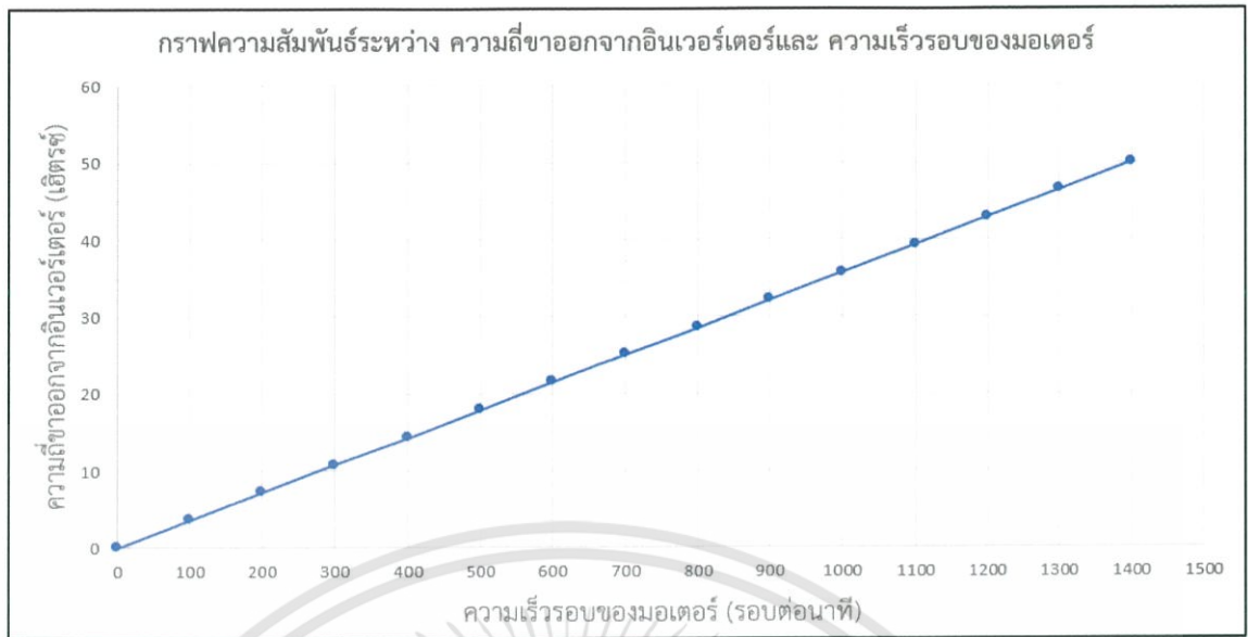
รูปที่ 4.3 กราฟความสัมพันธ์ระหว่างความถี่ขาออกจากอินเวอร์เตอร์และความเร็วรอบของมอเตอร์
