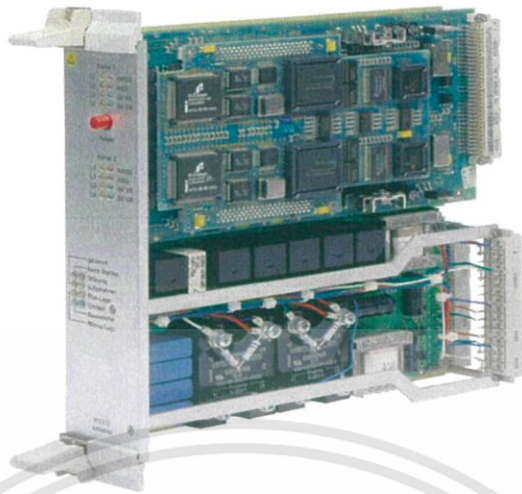
รูปที่ 2.22 โมดูลอินเทอร์เฟซประแจกลไฟฟ้า (WESTE)
