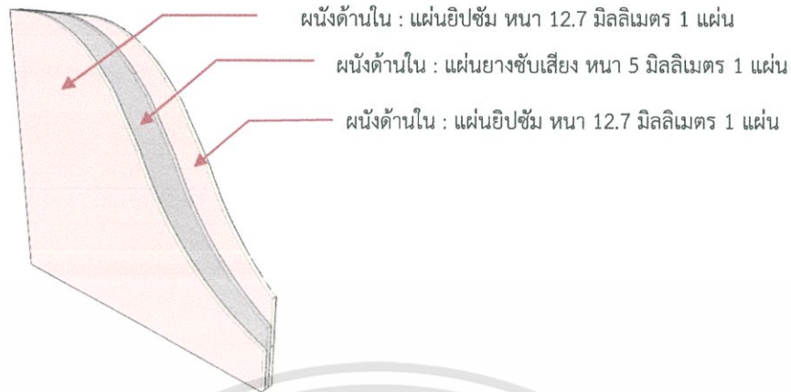
รูปที่ 3.5 แสดงส่วนประกอบของผนังรูปแบบ C
