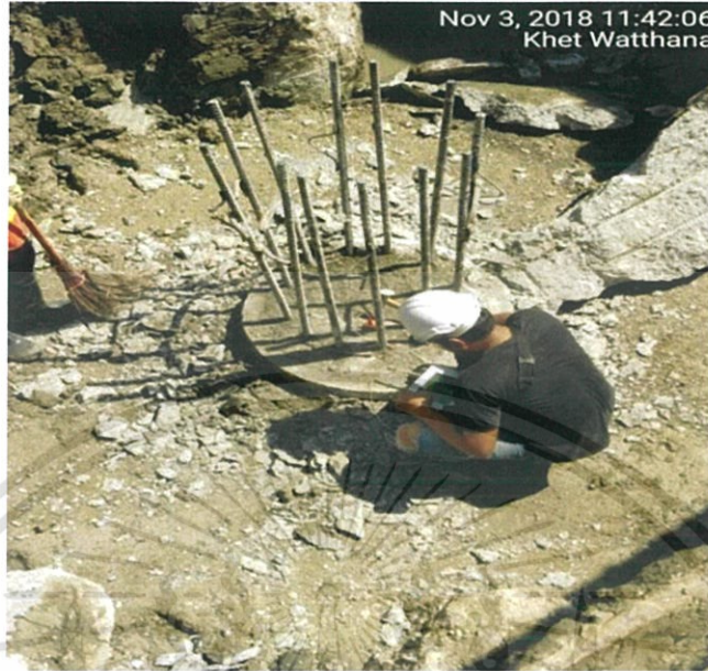
รูปที่ 3.14 การทดสอบความสมบูรณ์ของเสาเข็มด้วยวิธี Seismic Integrity Test (ที่มา: โครงการ The Fine Bangkok)
