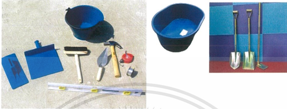
รูปที่ 2.3 ชุดเครื่องมือในการก่ออิฐมอญ
