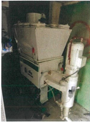
รูปที่ 3.23 เครื่องพ่นปูน(Spraying Machine) 3). ใช้เหล็กสามเหลี่ยมปาดแต่งผิวปูนฉาบให้เรียบ
