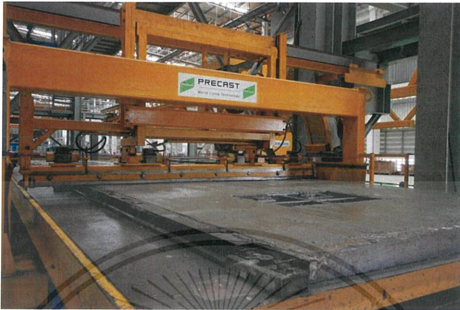
รูปที่4.9 การปาดแต่งผิวหน้าด้วยเครื่องจักรแทนแรงงานคน
