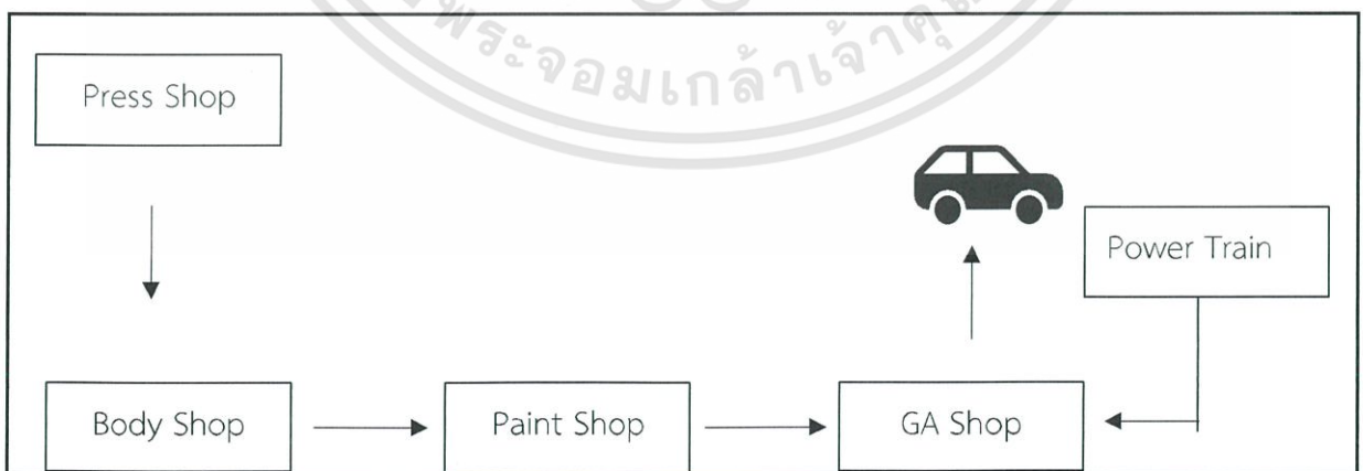
รูปที่ 3.1 แผนผังการประกอบรถของโรงงานผลิต
