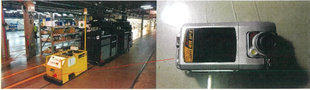
รูปที่ 3.7 รูปตัวอย่างกล้องวีดีโอที่ใช้บันทึกวีดีโอเปรียบเทียบความเบี่ยงเบนจากแถบแม่เหล็ก
