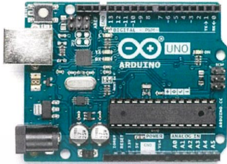
รูปที่ 2.11 บอร์ด Arduino UNO
