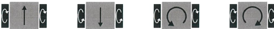
รูปที่ 2.1 รูปแบบการเคลื่อนที่แบบ Differential Drive
