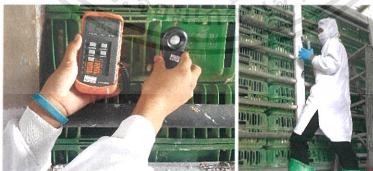
รูปที่ 3.2 แสดงขั้นตอนการเก็บข้อมูลความเข้มแสง
