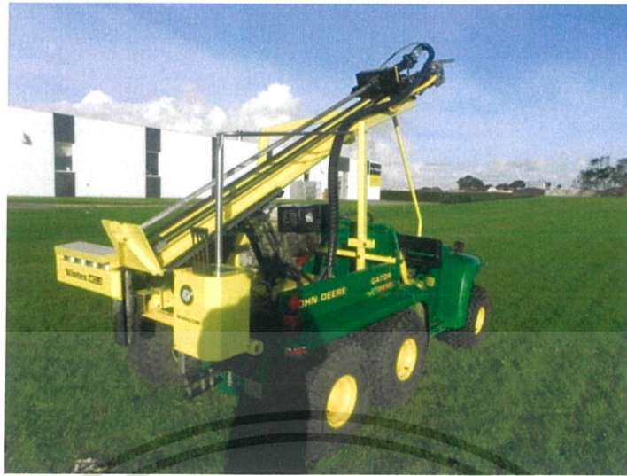
ภาพที่ 2.6 เครื่องเก็บตัวอย่างดิน รุ่น WINTEX MCL3
